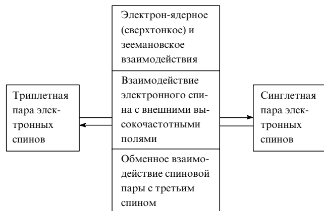
Рис. 1. Схема взаимодействий, индуцирующих спиновую конверсию спиновых пар
